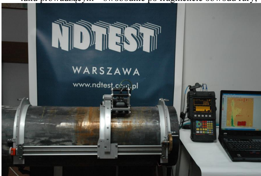
Rys.12. System NDTEST do sporządzania ultradźwiękowych map korozji na elemencie rurowym o średnicy nominalnej DN 300
