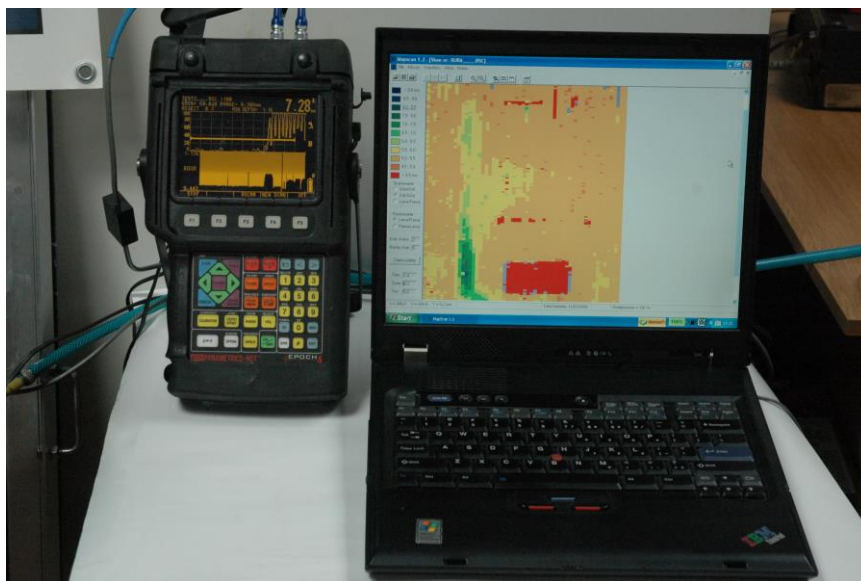
Rys.13. Przykładowy zapis profilu grubości (B-scan) w aparacie Epoch 4 dla wybranego przekroju grubości blachy oraz zapis mapy korozji przetworzonej przez oprogramowanie Mapscan w laptopie
